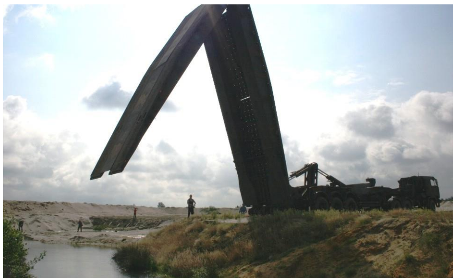
Rys 4 Most samochodowy MS-20 – produkt zaprojektowany w OBRUM i produkowany wspólnie z Zakładami Mechanicznymi Bumar-Łąbedy. Projekt jest przykładem ścisłej współpracy spółek zarówno na poziomie rozwoju produktu jak i jego wdrażania do Wojska Polskiego.
