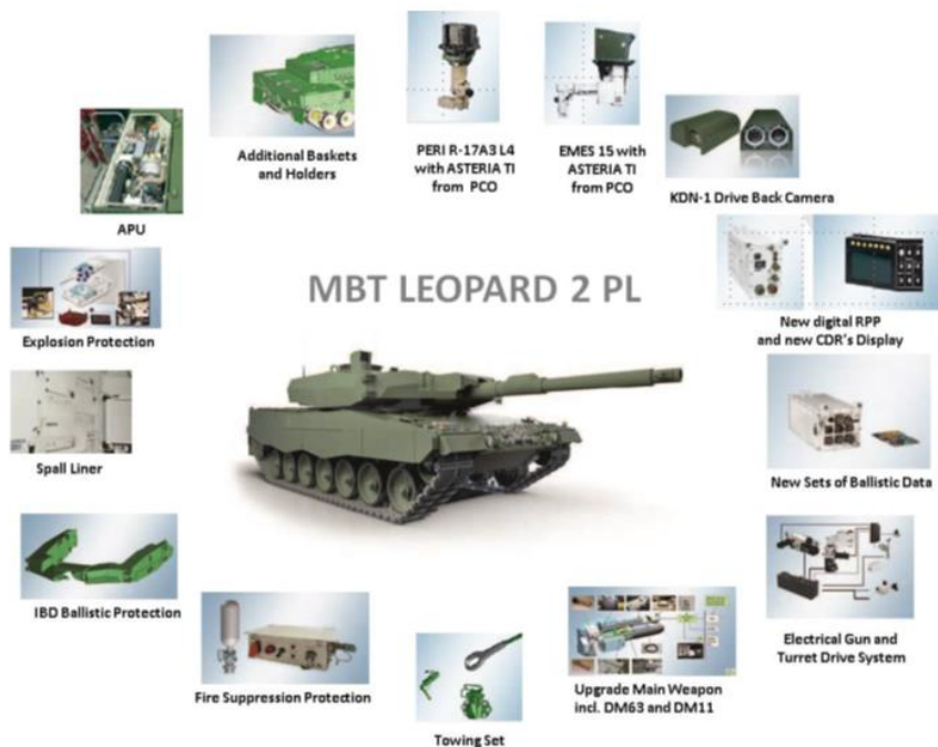
Rys 16 Zakres modernizacji czołgu Leopard do wersji 2PL
