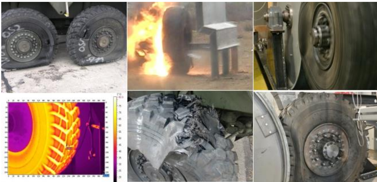
Rys. 19 Badania ogumienia pojazdów wojskowych w trakcie eksplozyjnego uszkodzenia. W konsorcjum realizującym temat udział brała Politechnika Krakowska, Wojskowy Instytut Techniki Pancernej i Samochodowej, Politechnika Gdańska, Politechnika Warszawska, Wojskowa Akademia Techniczna oraz ROSOMAK S.A. z Siemianowic Śląskich (rys www.wojsko-polskie.pl )
