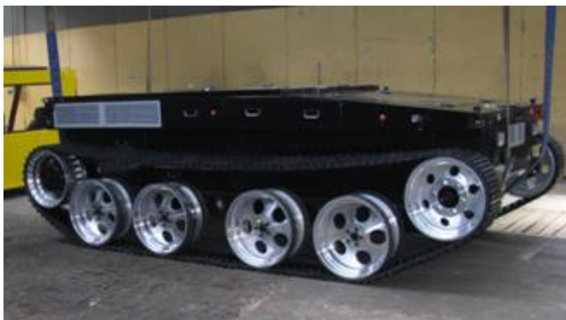
Rys 18 Podwozie autonomicznego Wielozadaniowego Inżynierskiego Pojazdu Hybrydowego – pojazd opracowany w ramach projektu Narodowego Centrum Badań i Rozwoju przez konsorcjum w składzie Politechnika Śląska, OBRUM i PIAP.
