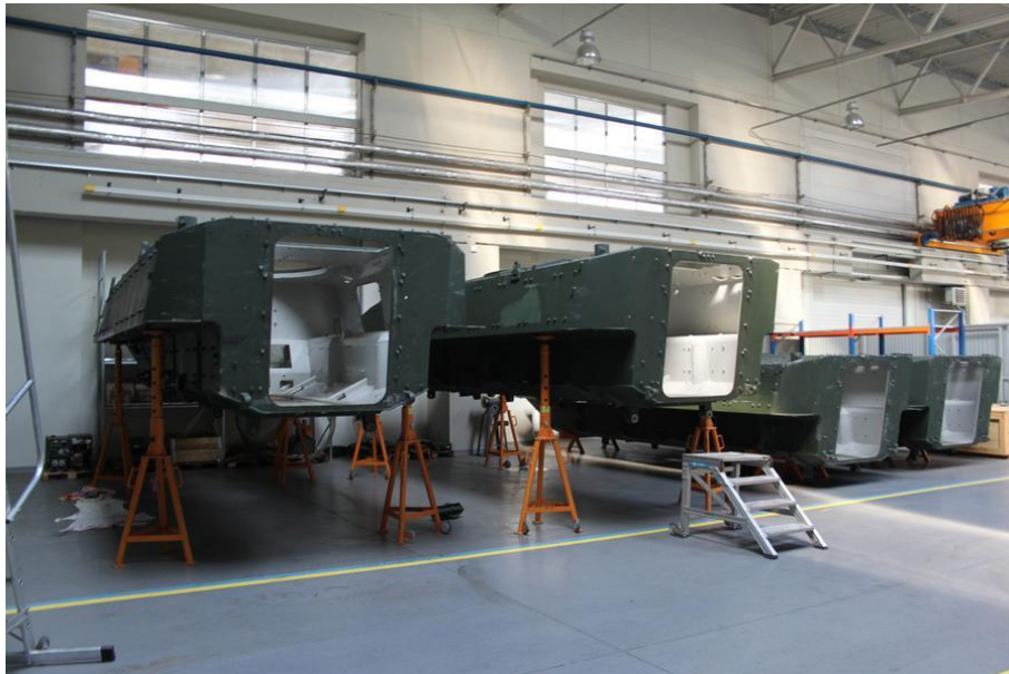
Rys22 Kadłuby pojazdów KTO Rosomak wykonane z polskiej stali pancерnej
