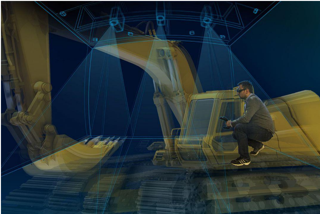
Rys. 1 Widok stanowiska do wizualizacji dokumentacji konstrukcyjnej w technologii kamer 3D, wykorzystywanego do projektowania w Ośrodku Badawczo Rozwojowym Urządzeń Mechanicznych w Gliwicach
