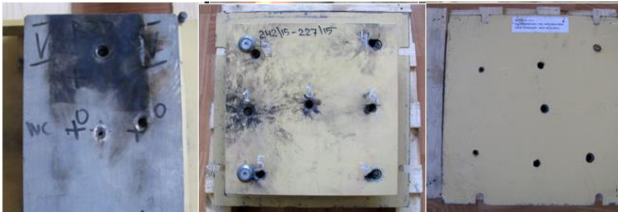
Rys 21 Badania próbek materiałowych pancerzy
