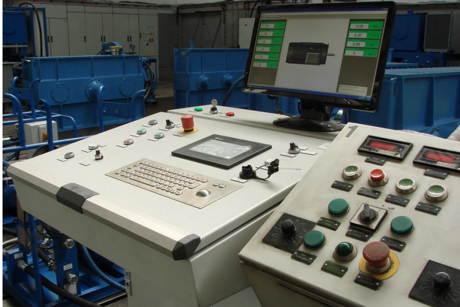
Rys 13 Widok stanowiska OBRUM do badań układów napędowych
